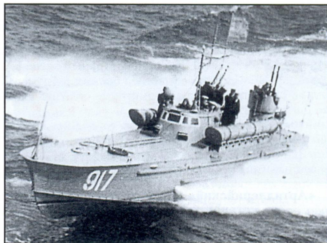
Торпедный катер типа «Комсомолец» в окончательном варианте с трубчатыми торпедными аппаратами
