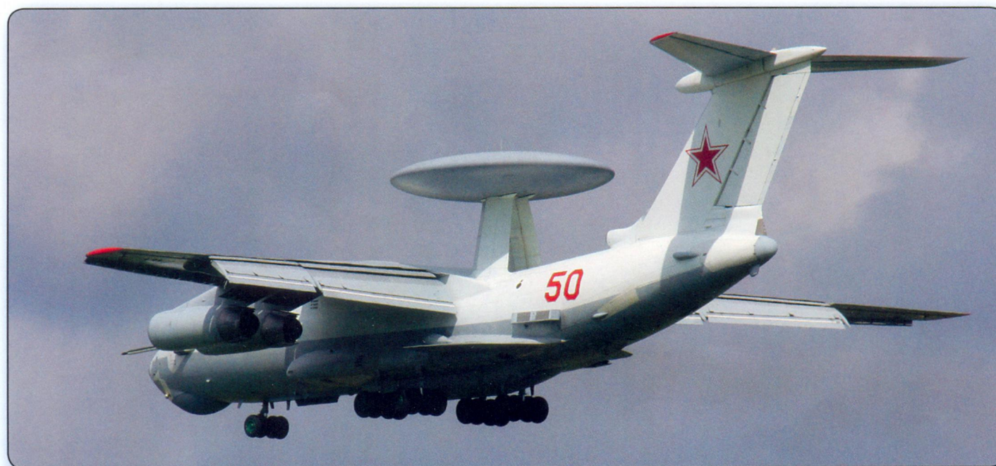
«Летающий радар» – самолет дальнего радиолокационного обнаружения и управления А-50. Кстати, обратите внимание на выпущенные многоцелевые закрылки. Это хорошая иллюстрация к первой статье.
