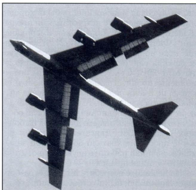
Хорошо видно, как увеличивается площадь крыла после выпуска закрылков
