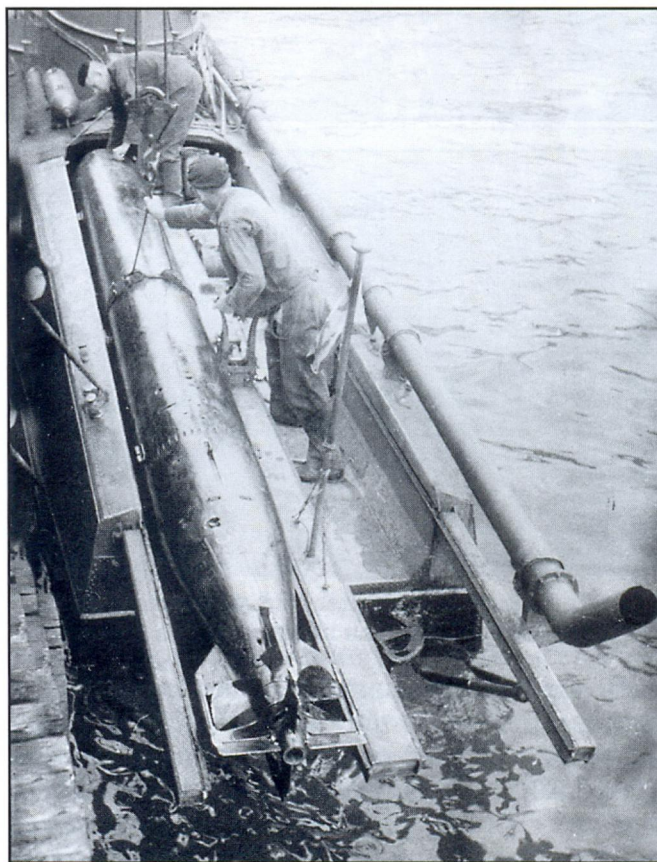
Погрузка 533-мм торпеды в желобной торпедный аппарат катера Г-5
