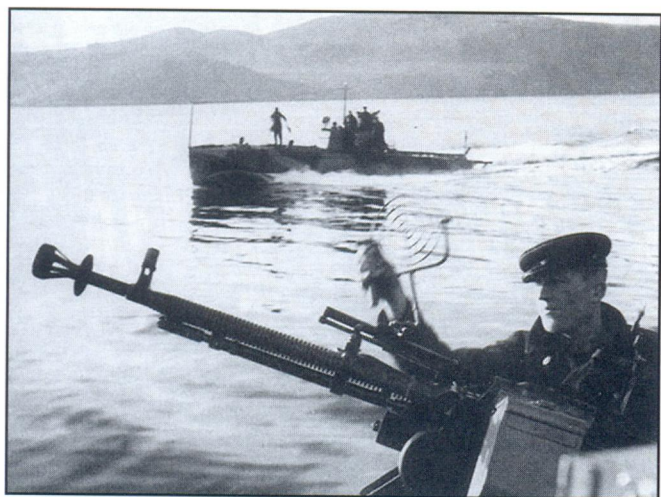
Крупнокалиберный 12,7-мм пулемет ДШК – основное стрелковое вооружение Г-5
