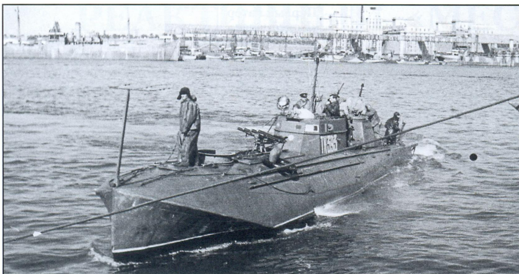
Торпедный катер Г-5 Черноморского флота. Перед рубкой установлена горная пусковая установка 82-мм реактивных снарядов — экспромт моряков
