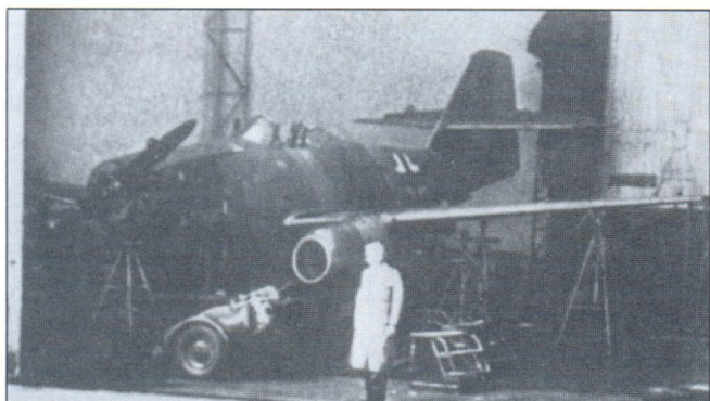
Me 262 V1 с двумя турбореактивными двигателями BMW и одним поршневым двигателем Jumo 210G
