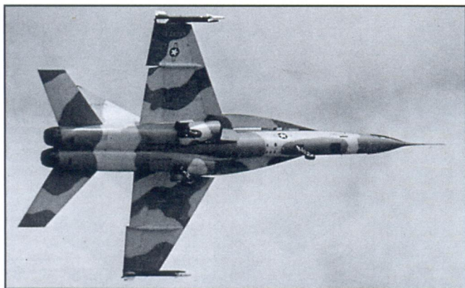
Опытный истребитель YF-17 — первый самолет с характерными наплывами в корне крыла
