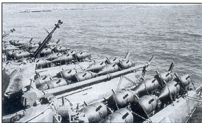
В желоба торпедных аппаратов катеров Г-5 загружены морские мины типа «Рыбка» — эффективное средство против вражеского «москитного» флота
